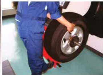
両手でのホイールセットで装着誤差低減
